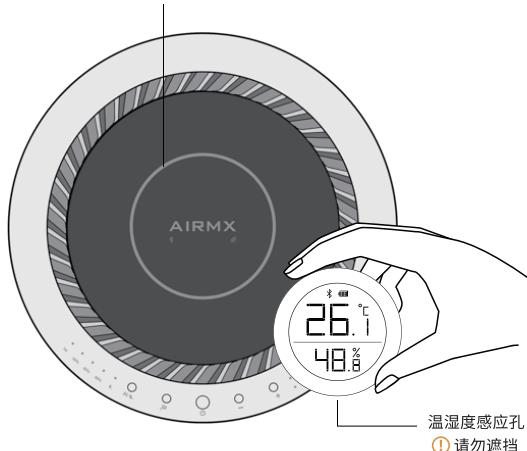
将蓝牙温湿度计靠近 AirWater A3 0.5米即可自动配对。
