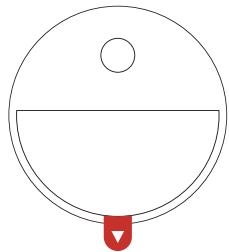
拔出蓝牙温湿度计下方的塑料绝缘条。
